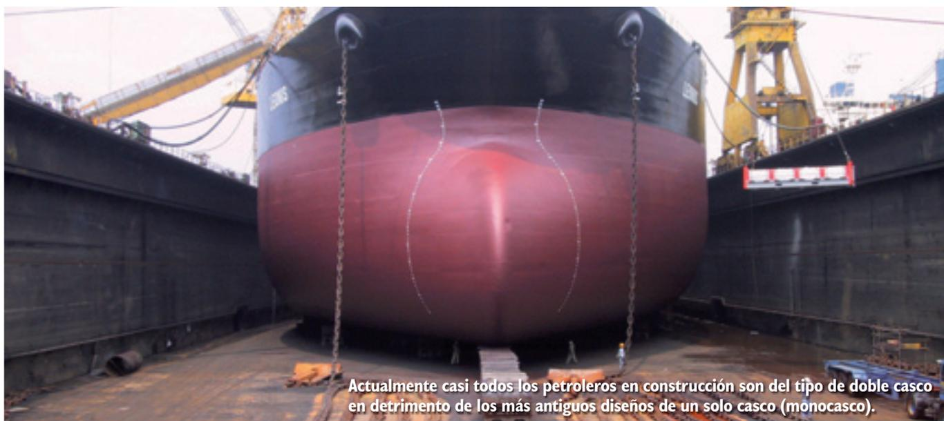
Actualmente casi todos los petroleros en construcción son del tipo de doble casco en detrimento de los más antiguos diseños de un solo casco (monocasco).
